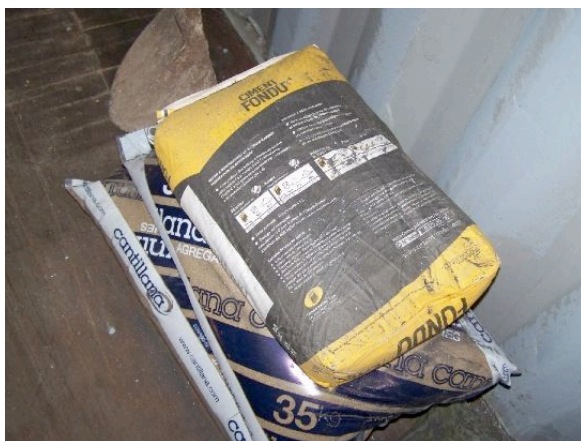
Deux sacs de 25kg de ciment « fondu » pour le sol, avec le sable correspondant (généralement 40L de sable pour 25kg de ciment)
