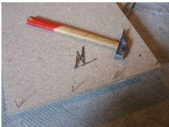
Photo 3 – Enfoncer légèrement les clous aux extrémités des panneaux de côtés (C et D)
