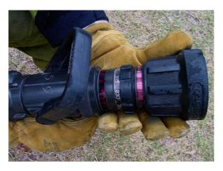
Pour une plus grande efficacité de refroidissement des gaz de combustion aériens (plafond de fumée), par impulsions, la lance doit être réglée à d'environ 115 l/mn à 7 bars relatifs. Le mode de spray avec de l'eau finement divisée en gouttelettes permettra une application optimisée.
