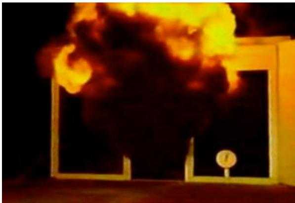
*Phase d'expiration. La totalité de l'ouvrant est utilisé pour la sortie des fumées.*
