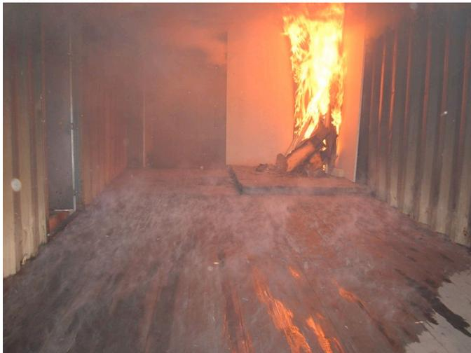
*Mouvement de l'air au sol dans un caisson flashover. Plus le feu prend de l'ampleur et plus ce mouvement s'accélère. Le déplacement des fumées au sol atteint facilement plusieurs mètres à la seconde.*
