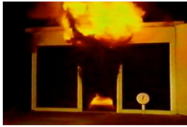
*Phase d'aspiration du comburant. L'air frais rentre par le bas, moins d'extraction de fumées*
