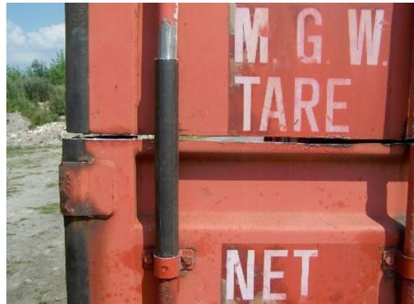
Afin de permettre une ouverture simultanée de la partie haute et de la partie basse, il est possible de faire coulisser un tube sur les deux systèmes de commande. Il faudra simplement veiller à retirer ce tube (ou à le mettre) en fonction du type de brûlage.
