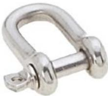
Pour fixer les chaînes entre elles et pour les fixer sur les anneaux, prenez des manilles (*cf. photo de gauche*) et pas des anneaux « vissés » car ceux-ci ont un écartement trop faible, surtout pour les fixations dans les angles du caisson, dont la tige d'acier est généralement d'un diamètre plus gros que celle des anneaux en haut et en bas du caisson.
