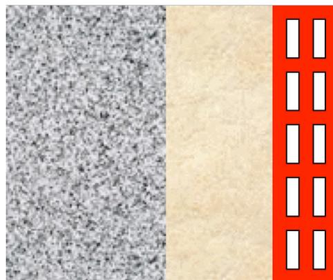
Béton                      Laine de verre                      Brique creuse
