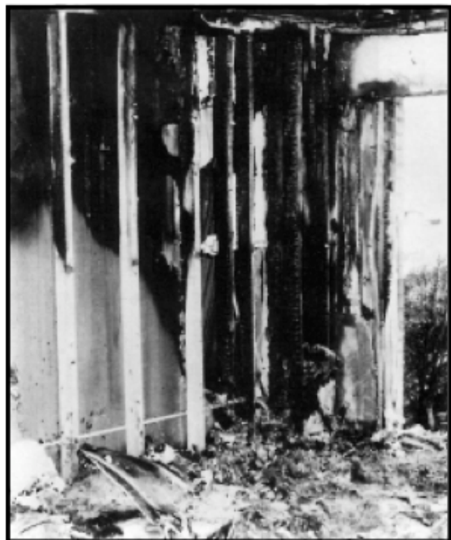
Figure 2. NFPA 921-2004 (Figure 6.17.2) Forme en V typique, montrant les dommages sur un mur et sur les montants en bois.
